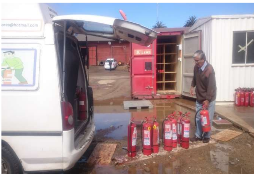
Mantención y recarga de extintores portátiles.
